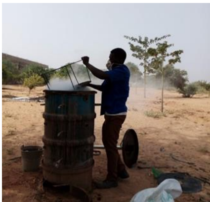
Figure 11 : Mise en place de la grille de l'étage n°2
